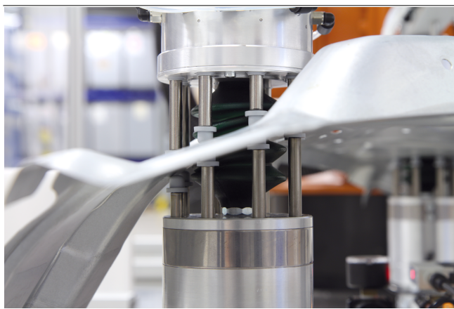
Boca de ventosa SSCB durante el agarre y la fijación automatizados de una pieza de chapa
